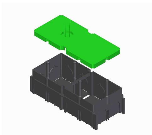
El montaje de la tapa ciega para obra se realiza mediante presión, y para retirar se estira de los filamentos que quedan a la vista después de enlucir.
